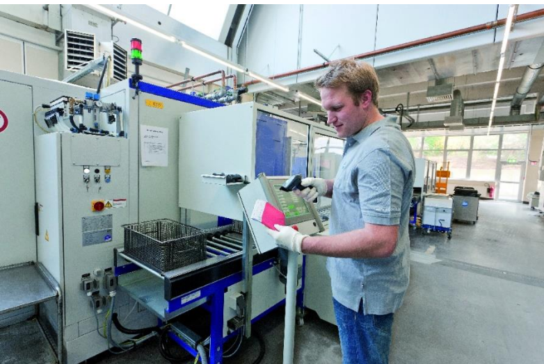
Nach verschiedenen Bearbeitungsschritten wie Zerspanen, Schleifen und Beschichten durchlaufen die Teile Reinigungsprozesse in den Lösemittelanlagen. Die Auswahl des jeweiligen Reinigungsprogramms erfolgt durch Barcodes.
