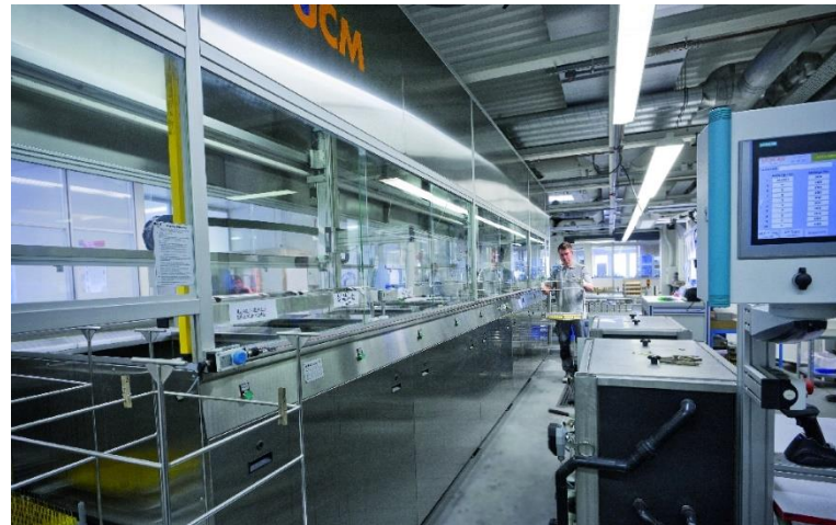
Die erste Reinigungsstufe der Ultraschallanlage für die Produktionsendreinigung ist mit drei separaten Reinigungsbecken ausgeführt. Dies ermöglicht, die Teile aus verschiedenen Werkstoffen getrennt zu reinigen.
