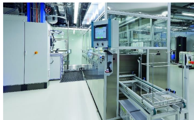
Bei der Anlage für die Endreinigung werden die Teile direkt in den Reinraum ausgegeben. Die Anlage und die Transporteinheit in den Reinraum sind vollständig gekapselt.
